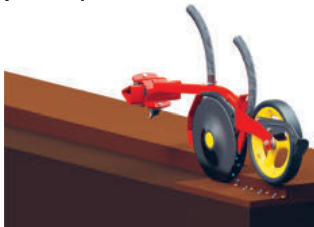
Versiunea InLine plasează fertilizatorul într-o intrare separată împreună cu semințele în brăzdarul de semințe.
