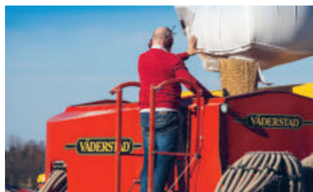
Modelul pentru semințe Spirit 600-900S are capacitatea buncărului de 3900 litri.
