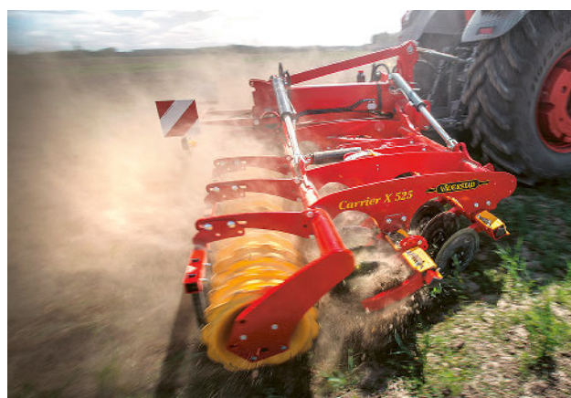
Adâncimea de lucru este reglată din cabina tractorului, făcând astfel ușoară adaptarea la condițiile variate din sol.
