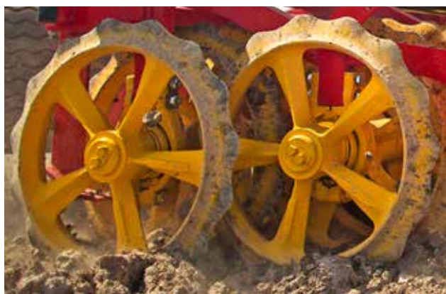
Inelele tăvălugului sunt montate decalat, minimizând astfel efectul de buldozer și scăzând necesarul de putere.
