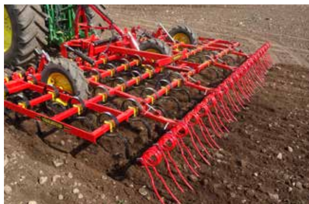
Pentru finisarea patului germinativ, grapa de acoperire creează o barieră împotriva evaporării prin sortarea la suprafață a agregatelor mai mari și resturilor vegetale.
