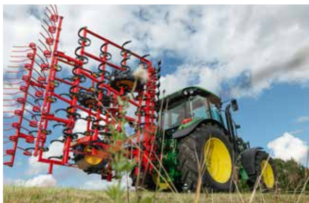
NZ purtat se pliază la 2.05 m lățime de transport, asigurând astfel transportul facil între sole.
