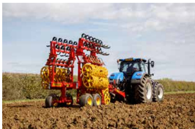
Sistemul de pliere Väderstad oferă RexiusTwin 3m lățime de transport.
