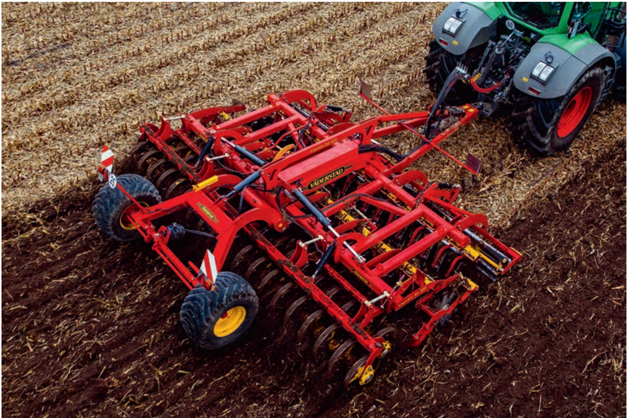
Șasiul robust și discurile de 61 cm oferă Carrier XL greutatea și puterea necesară pe câmp în resturi vegetale multe și dense.
