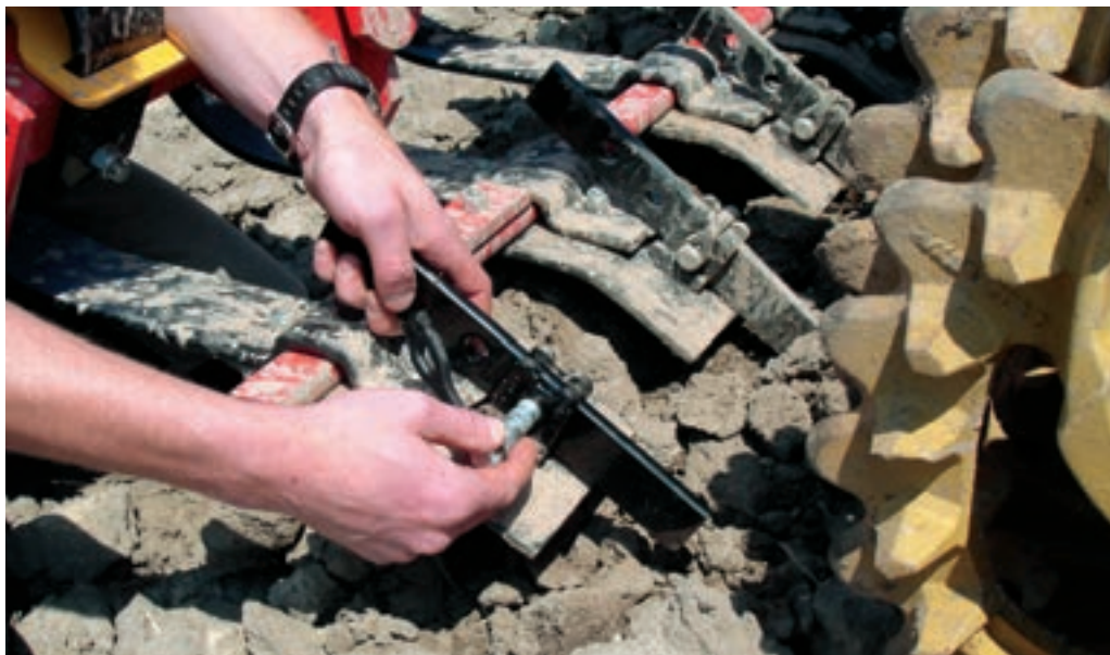
Cuțitul Singular. Ușor de atașat datorită sistemului Väderstad QuickChange.
