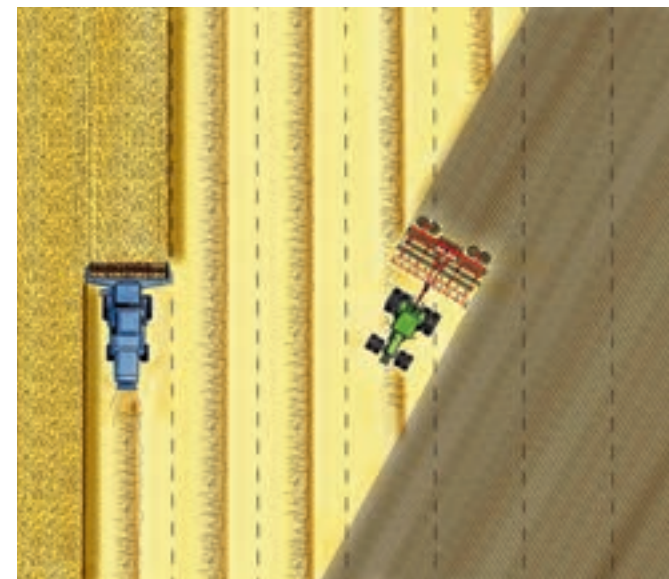
Carrier cu grapă de paie este operat în diagonală la direcția de recoltare.
