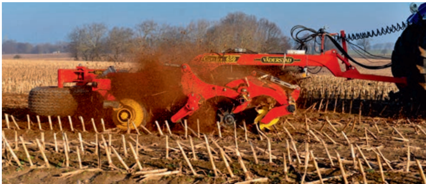
Combinația disc-cuțit CrossCutter controlează molia porumbului prin spargerea tulpinilor între noduri. Tăvălugul SteelRunner sparge resturile și le amestecă cu solul.
