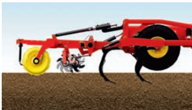
În condiții de uscăciune întreaga greutate a mașinii poate fi lăsată pe tăvălug.
