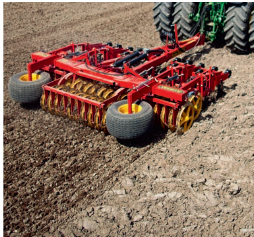
Pentru a crește spațierea în echipamentul frontal, tăvălugul poate fi dotat cu o a treia axă. Aceasta asigură un flux mai bun de material prin mașină, permițând astfel cantităților mai mari de paie și resturi vegetale să treacă prin utilaj.
