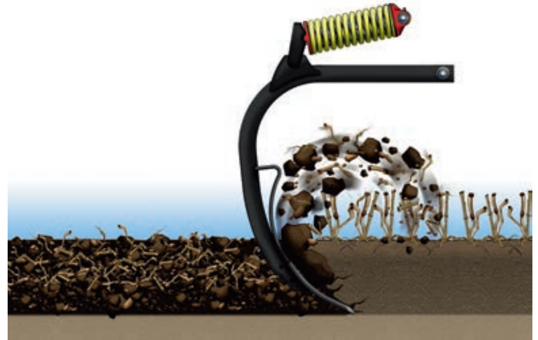
Cu ajutorul cormanei MixIn materialul pe întregul orizont de cultivare este mărunțit și amestecat.
