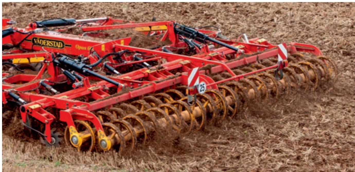
SoilRunner este un tăvălug cu profil U unde solul lucrează pe sol.
