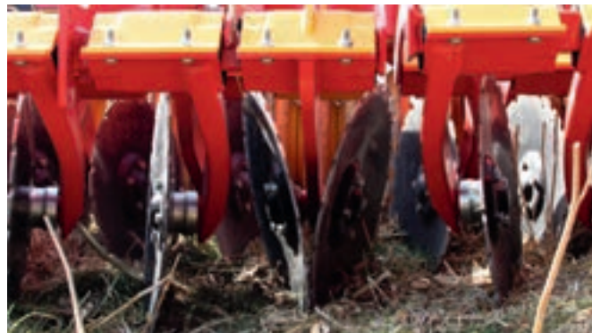
Discurile sunt montate individual cu o suspensie fără întreținere din cauciuc. Aceasta crește precizia atât pe verticală cât și orizontală și asigură flux maxim de material.
