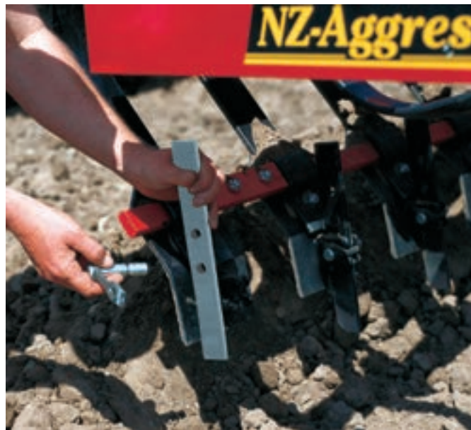
Cu ajutorul accesoriului Cuțit singular montat pe bara de nivelare CrossBoard, efectul de cultivare este mai intens. Folosind sistemul de schimbare rapidă Väderstad aceste accesorii pot fi montate fără ajutorul sculelor.
