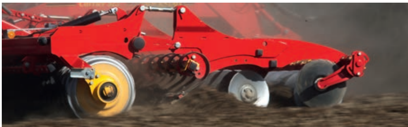
Bara stabilizatoare cu dublă acțiune creează efectul de nivelare în două direcții, în față și în spate.
