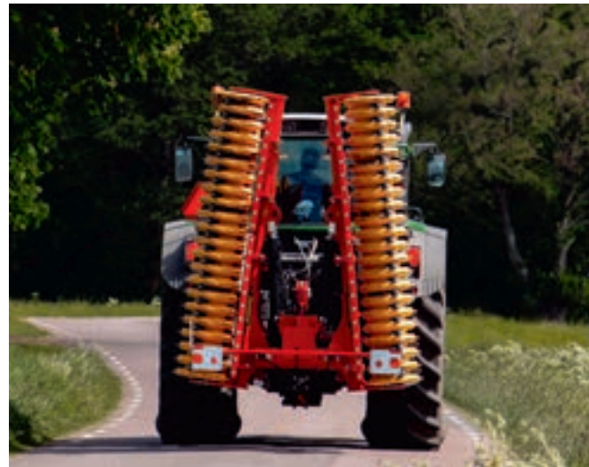
Pliat în transport, Carrier X are numai 2.4 m lățime și o gardă la sol impresionantă.
