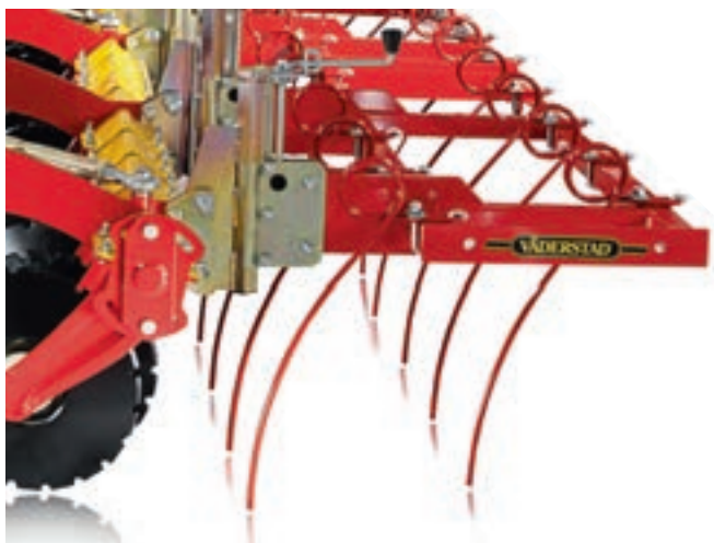
Grapa de paie este ușor de atașat și înălțimea este reglabilă.
