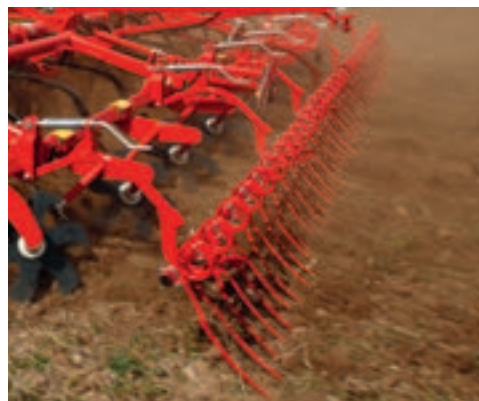
Swift poate fi dotat fie cu grapă de acoperire cu dinți normali de 12 mm sau cu dinți puternici de nivelare de 9.5 x 45 mm.
