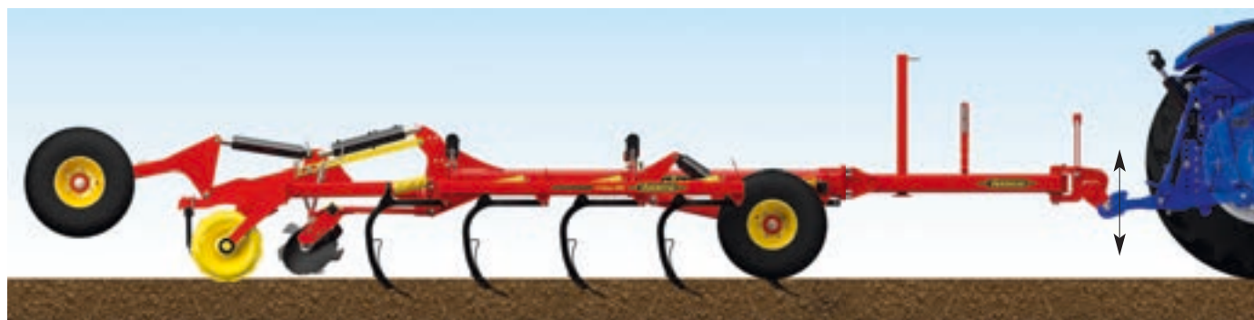
Cu bara de tracțiune hidraulică bine ajustată, necesarul de putere poate fi redus.
