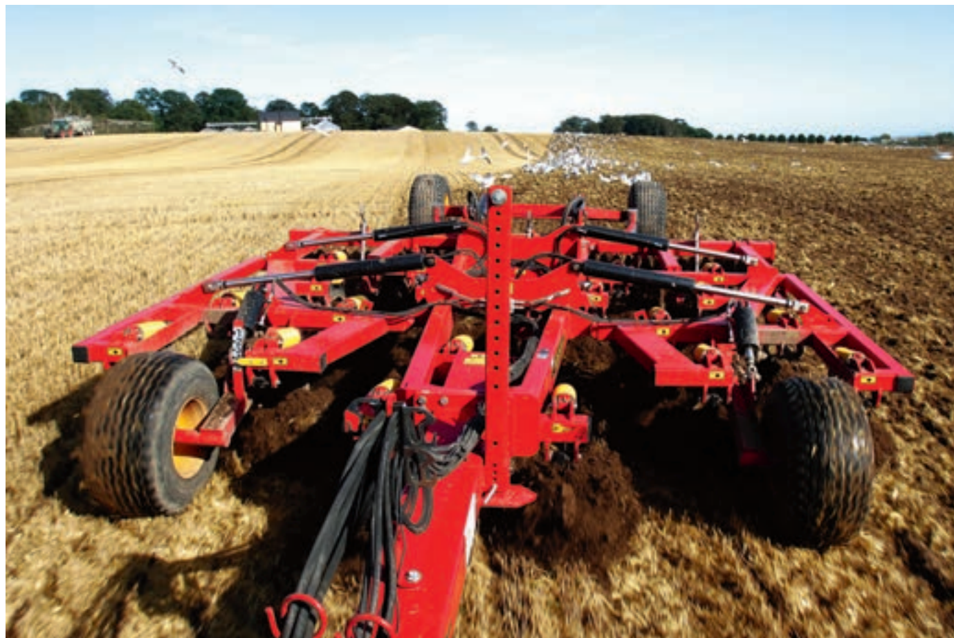
Roțile late de sprijin din față permit Cultus-ului să mențină controlul excelent asupra adâncimii de lucru. Acestea sunt ușor de ajustat din cabina tractorului, ceea ce este esențial pentru o cultivație bună pe terenurile variate.
