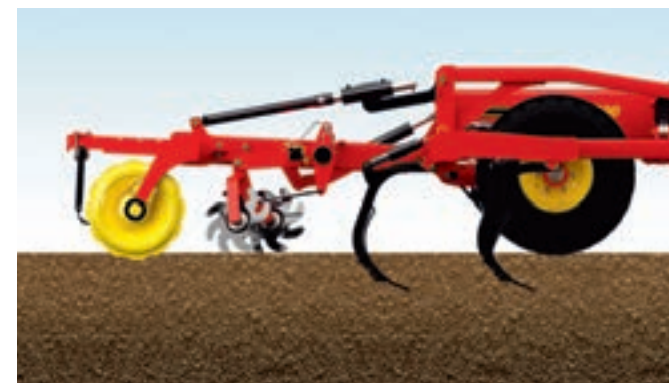
Pe solurile mai ușoare tăvălugul poate fi ridicat astfel încât să nu afecteze suprafața.
