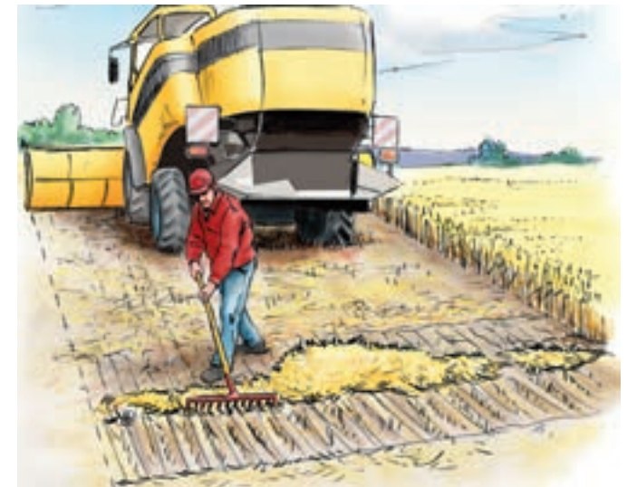
Este ușor de testat rezultatul distribuției paietelor în urma combinei – greblați un metru în urma combinei, pe întreaga lățime a platformei.
