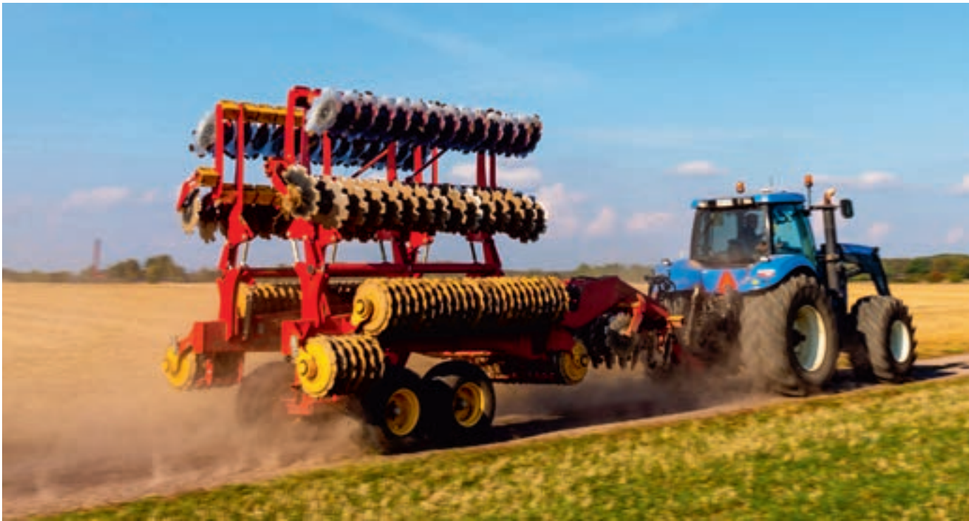
Carrier XL 9.25 și 12.25 se pliază în sistemul Väderstad. Toate modelele au maximum 3 m lățime de transport.
