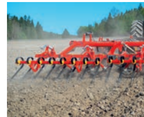
Swift poate fi dotat fie cu grapă de acoperire cu dinți normali de 12 mm sau cu dinți puternici de nivelare de 9.5 x 45 mm.
