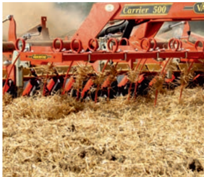
Grapa de paie distribuie în mod eficient paietele pe întreaga suprafață prelucrată.
