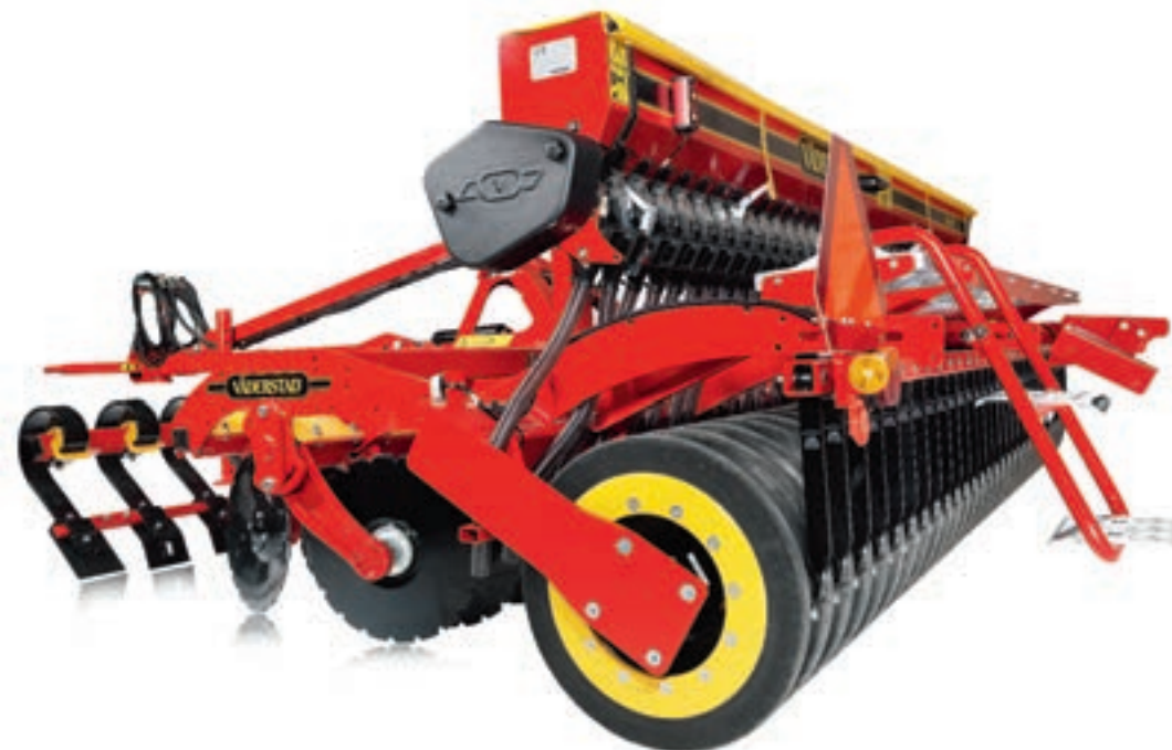
BioDrill BDX 180 și 250 reprezintă o soluție flexibilă cu un dozator rezistent ce permite semințelor să cadă sub propria greutate în sol.
