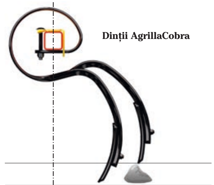
Dinții AgrillaCobra au o forță impresionantă de eliberare, înălțime mare dar și abilitatea de a menține adâncimea de lucru.
