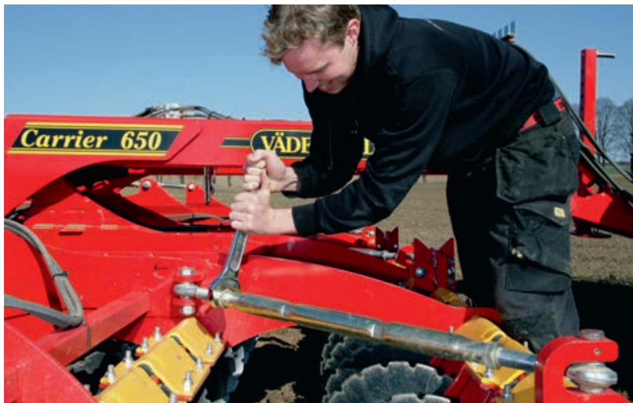
Axele sunt ajustabile în direcție laterală pentru rezultate optime de lucru.
