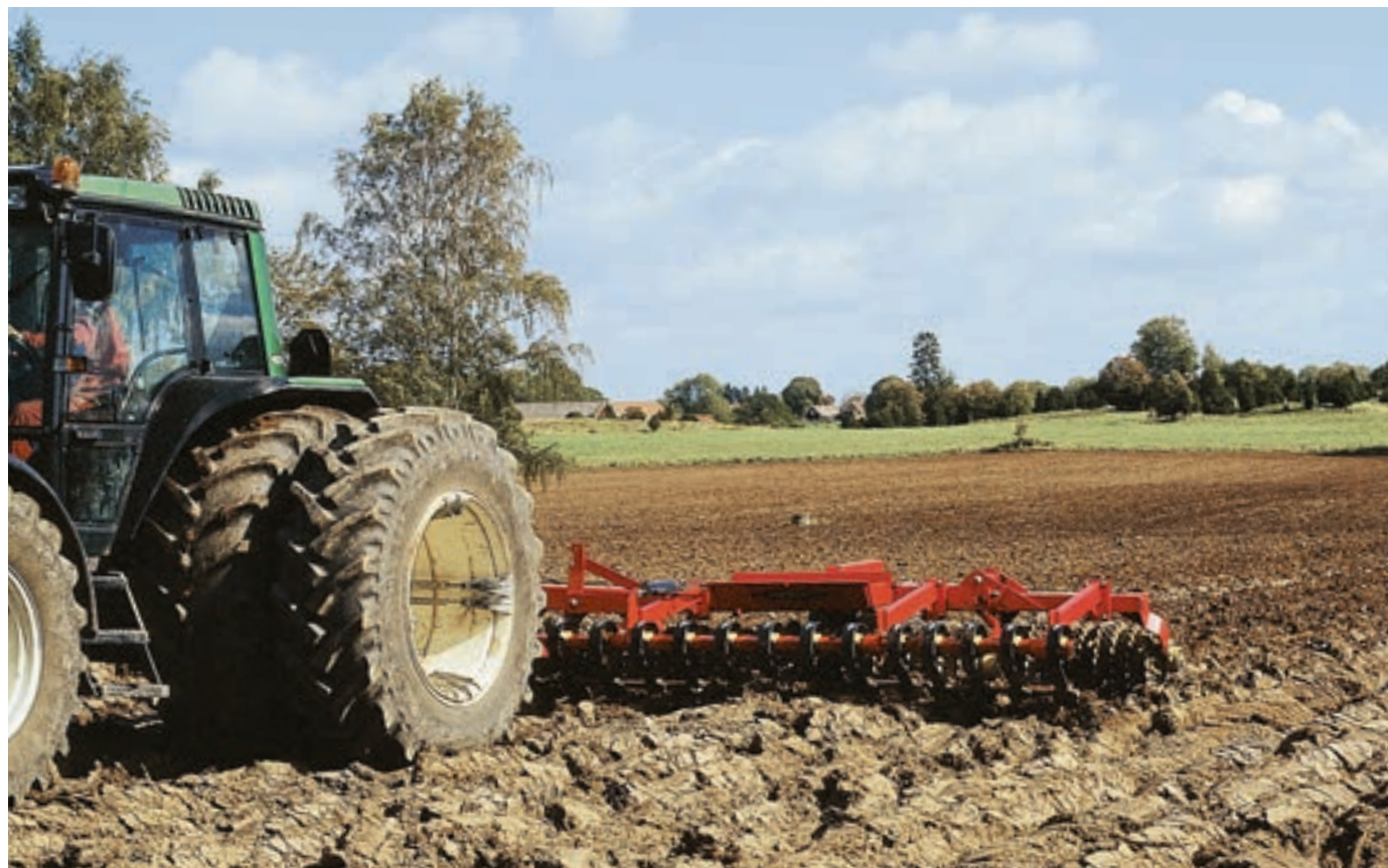
Cu ajutorul barei CrossBoard tăvălugul devine un utilaj eficient de nivelat brazdele.
