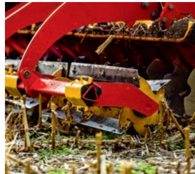
Cuțitele scurte și baza îngustă asigură un răspuns bun și rotație rapidă în lucru.
