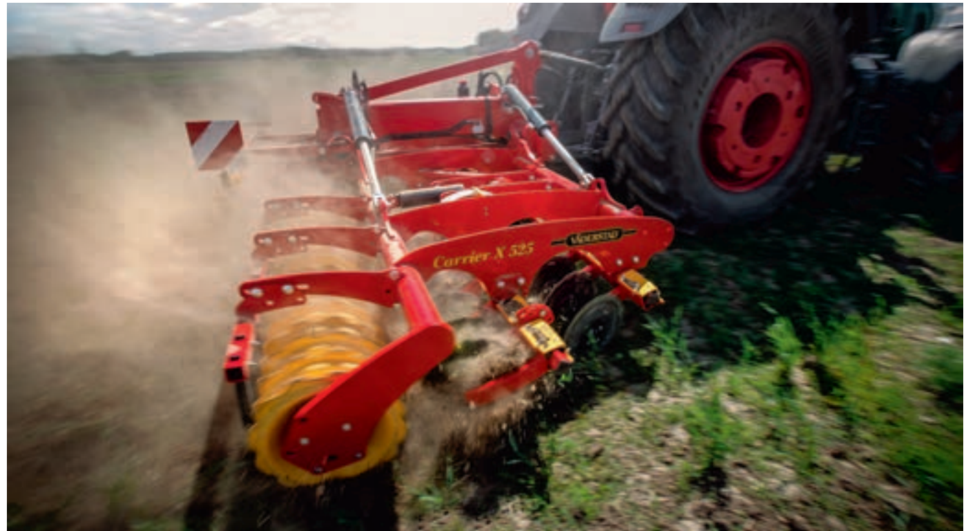
Poziționarea discurilor în formă de X permite lucrul cu GPS în câmp. Unghiul discurilor asigură penetrare perfectă.
