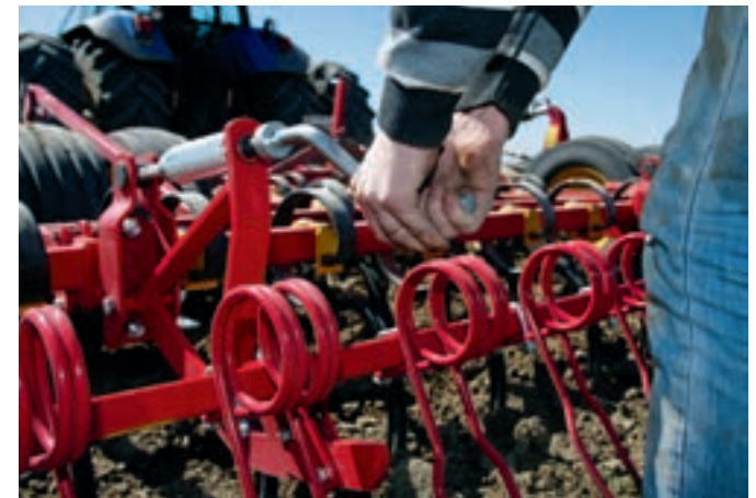
Grapa de acoperire, montată pe arcuri, poate fi reglată ușor pentru lucrări optime.
