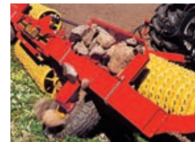
Tăvile sunt golite ușor prin simpla ridicare a utilajului cu ajutorul hidrauliciei.
