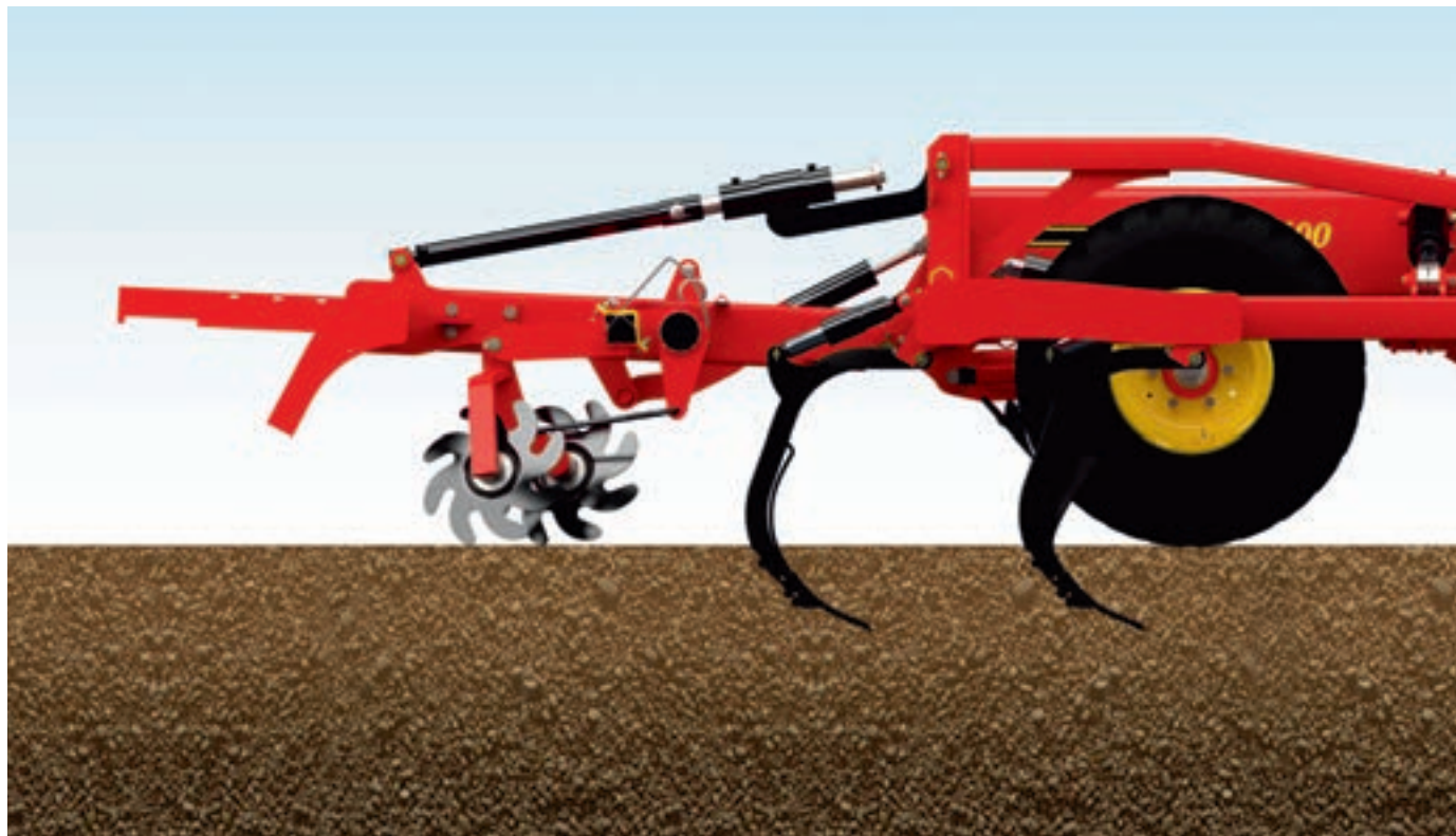
În condiții de umiditate, atunci când nu este nevoie de atât de multă greutate pe mașină, tăvălugul poate fi îndepărtat complet.
