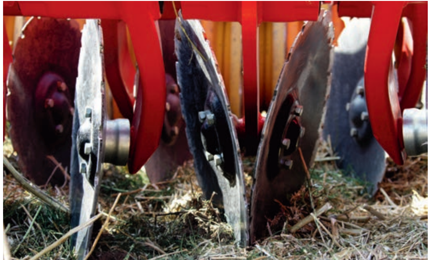
Disponerea în X ajută de asemenea la penetrarea mai bună în sol și menține mașina în linie dreaptă în spatele tractorului.
