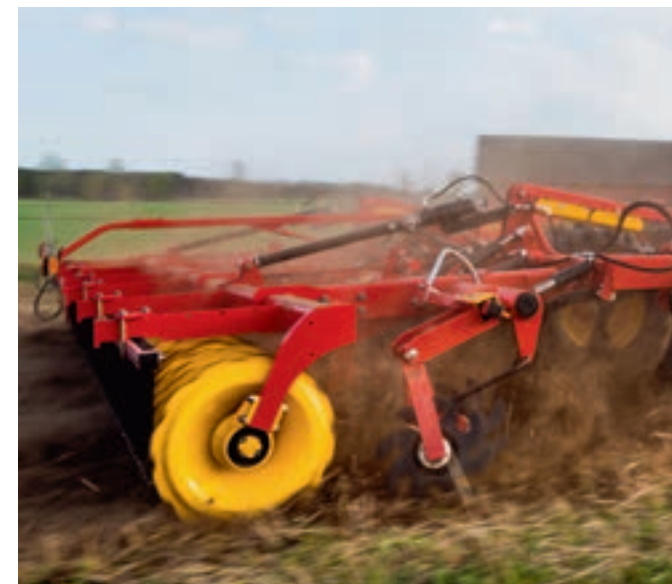
SteelRunner distruge resturile de la suprafață presându-le în stratul superficial de sol pentru a obține descompunerea optimă a acestora.
