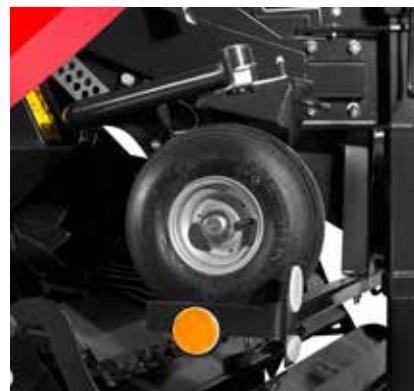
Pozitia de transport a rotii colectorului
