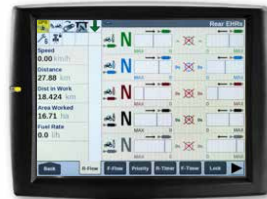
Prezentare dintr-o privire a setarilor de debit si temporizator pe monitorul AFS Pro 700™.
