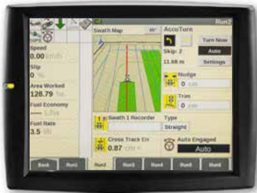
Proces automatizat de intoarcere cu AFS AccuTurn Pro
