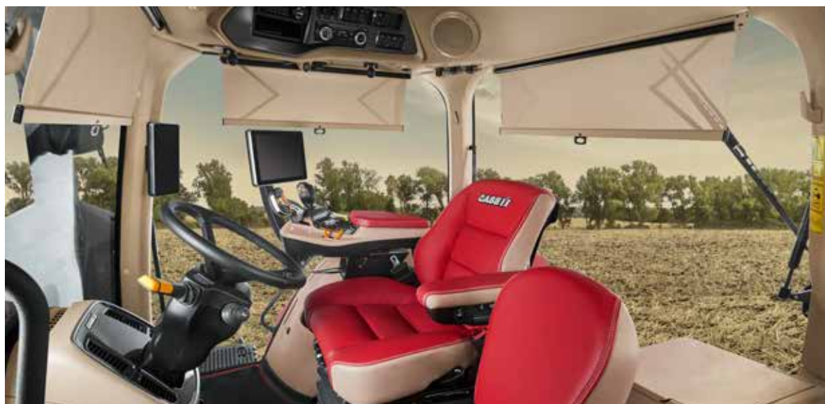
Suspensia hidraulica semiactiva a cabinei amortizeaza in mod fiabil socurile si vibratiile.
