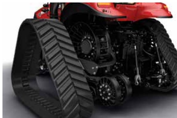
Sistemul de antrenare pozitiva elimina alunecarea intre roata de antrenare si senila din cauciuc in toate conditiile.
