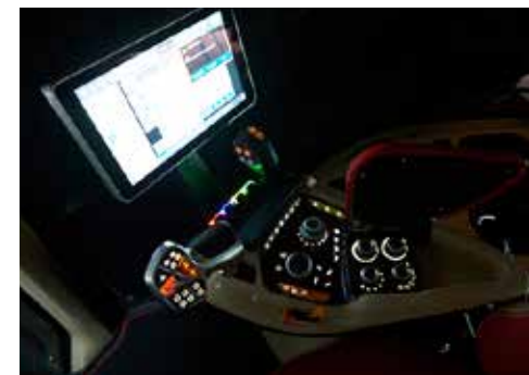
Pictogramele de pe toate comutatoarele sunt retroilluminate cand farurile sunt aprinse.
